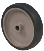
TPE (thermoplastischer Gummi) • hoher Fahrkomfort • geräuscharmer Lauf • spurlos (Werkstoff ist aber ölhaltig und kann bei empfindlichem Untergrund zu Kontaktverfärbungen führen) • geringer Rollwiderstand
